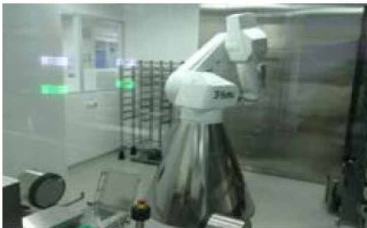
Ladestation Sybermat mit Laderoboter Stäubli
